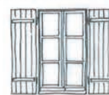
Volets pleins renforcés par des barres horizontales
